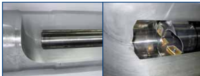
Doorsnede van een geboord gat
