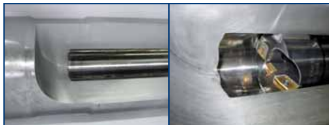
Doorsnede van een geboord gat
